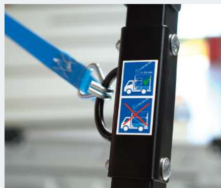
frei positionierbare Zurrkonsole* zur kraftschlüssigen Ladungssicherung
